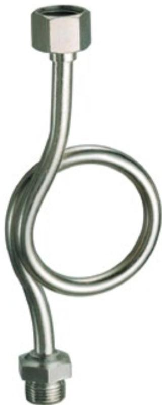
Serpentina portamanometro con attacco maschio fisso, calotta girevole e tubo Ø8mm. Tubo realizzato in rame (Cu999) e raccordi in ottone CW614N, con finitura nichelata.
