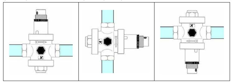
Il riduttore di pressione può essere danneggiato da impurità presenti nell'acqua; al fine di proteggere non solo il riduttore, ma anche tutti gli apparecchi a valle nell'impianto (miscelatori termostatici, rubinetteria sanitaria, docce, ecc.) consigliamo di installare un filtro autopulente a monte del riduttore di pressione.
