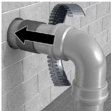
4. Collocare il collare sul nastro intumescente già posizionato sul tubo.
