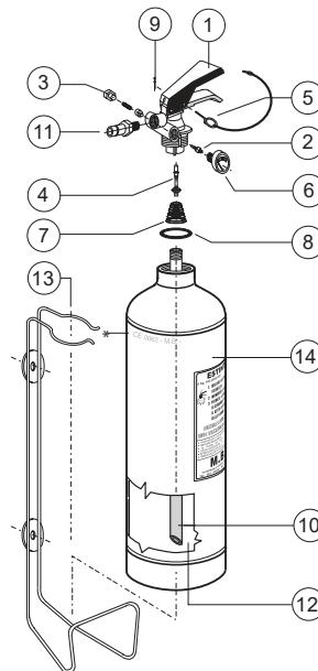
\*\* Marchiatura serbatoio (Ente di Sorveglianza) **CE 1370**, produttore serbatoio, decimale anno produzione, (codice identificativo produttore) **0095**, n° matricola serbatoio, (Pressione di collaudo) PT xx Bar.
