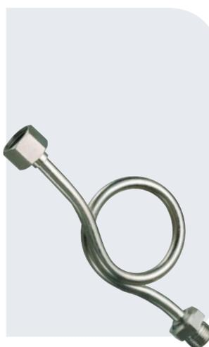
Tipicamente installata tra il rubinetto portamanometro e il manometro, evita i colpi d'ariete e diminuisce la temperatura del fluido, preservando lo strumento di misura.
