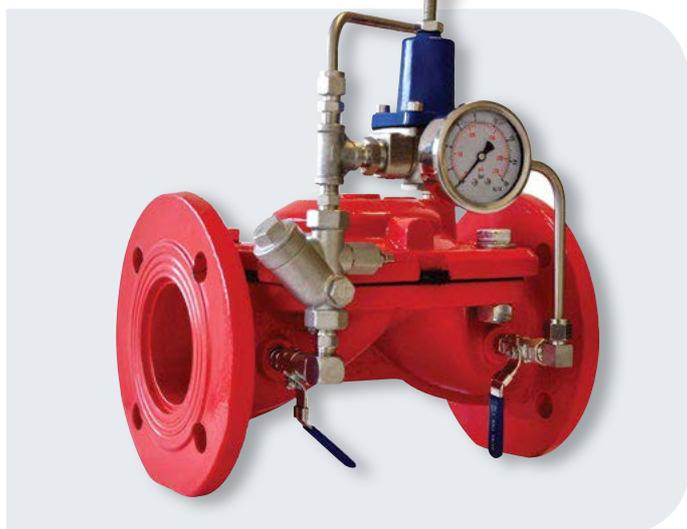
Valvola di riduzione della pressione, tipicamente utilizzata sulle linee antincendio al fine ridurre e stabilizzare la pressione a valle, indipendentemente dalla richiesta e dagli sbalzi a monte. Facile regolazione di set point a mezzo del pilota.
