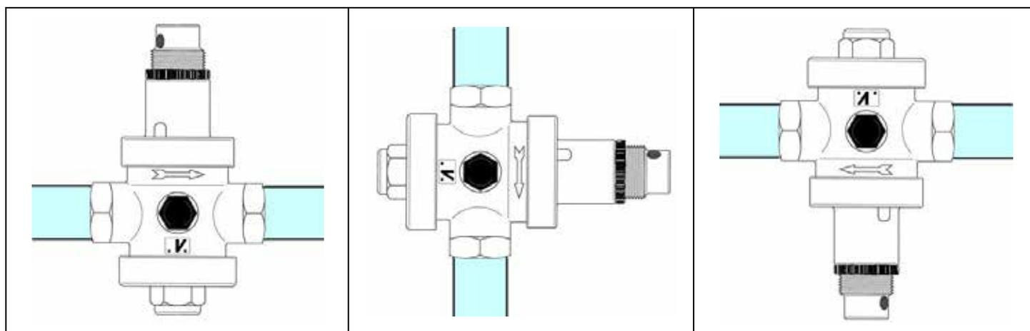
Il riduttore di pressione può essere danneggiato da impurità presenti nell'acqua; al fine di proteggere non solo il riduttore, ma anche tutti gli apparecchi a valle nell'impianto (miscelatori termostatici, rubinetteria sanitaria, docce, ecc.) consigliamo di installare un filtro autopulente a monte del riduttore di pressione.
